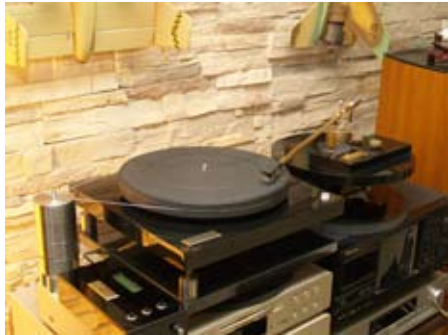
●這是 Mini Zenith 品牌創立後推出市場的第一件作品 Twin Star 機械懸浮唱盤，這部唱盤出了有精密的電子伺服電路控制 DC 直流馬達的轉速外，最特別的採用鑽石軸承的 Stand-Alone 單點唱臂，配上獨創的動態超距調整功能，可有效克服一般唱盤面臨的水平循軌角的誤差。
