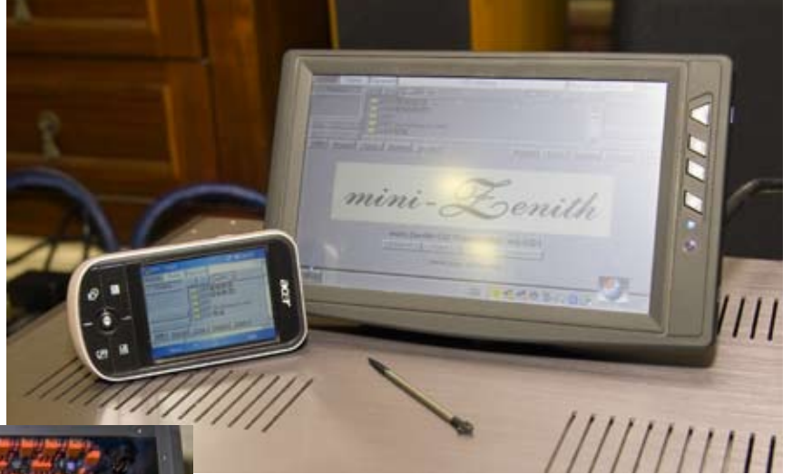
▲這就是操作 mz-CD1 轉盤的顯示幕（圖右）與 PDA 遙控器，可以看到連顯示幕上都有 mini-Zenith 自己的品牌標誌。
