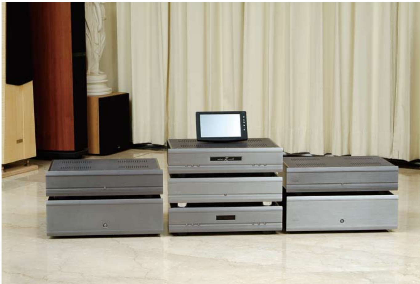
▲當天使用的所有器材。中間由上而下是 mz-CD1 轉盤 (包含顯示幕)、mz-DAC1 數位類比轉換器、mz-R1 前級。左右兩邊則是分體式的單聲道後級 mz-P1，與後級的分體電源供應 mz-P1p。這樣一套七件式的陣仗夠驚人吧？
