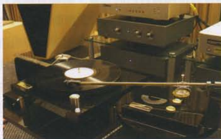
●Mini Zenith唱臂與尚未推出的唱盤，唱臂、轉盤、馬達與轉速控制器分別獨立，陳先生稱之為四件式設計。
