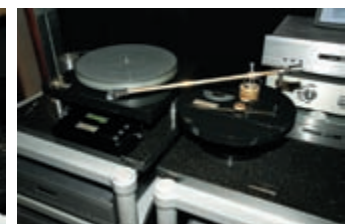
▲時間匆促，來不及聆聽LP，這組征宇音響的創世之作可是有故事的，鑽石支軸、單點支撐、微調臂座、電子控速，其成就不在其它產品之下。
