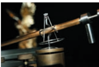
▲時間匆促，來不及聆聽LP，這組征宇音響的創世之作可是有故事的，鑽石支軸、單點支撐、微調臂座、電子控速，其成就不在其它產品之下。
