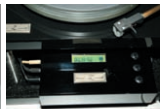
▲時間匆促，來不及聆聽LP，這組征宇音響的創世之作可是有故事的，鑽石支軸、單點支撐、微調臂座、電子控速，其成就不在其它產品之下。
